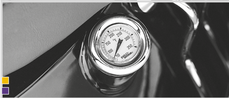
B. ÖLPEILSTAB MIT TEMPERATURANZEIGE (SOFTAIL ABGEBILDET)
